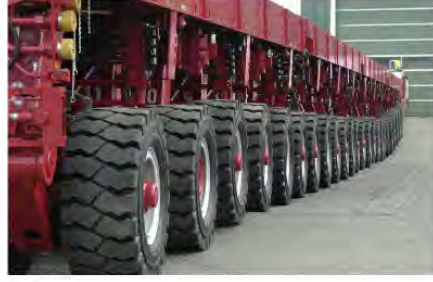
Şekil 2: Artuklu Hamamı'nın taşınmasında kullanılan araçların tekerlekleri
