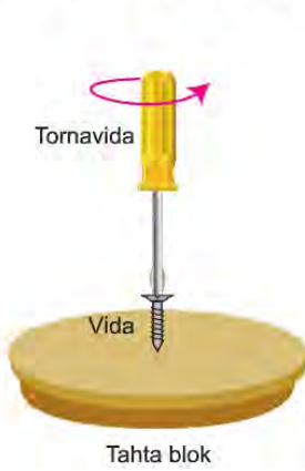
Şekil 1: Vida, tornavida ile döndürülerek tahta blokta ilerliyor.
