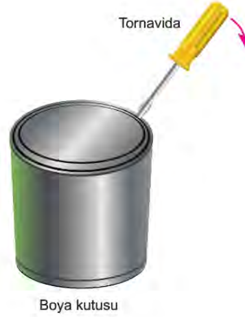
Şekil 2: Boya kutusunun kapağı tornavida ile açılıyor.
