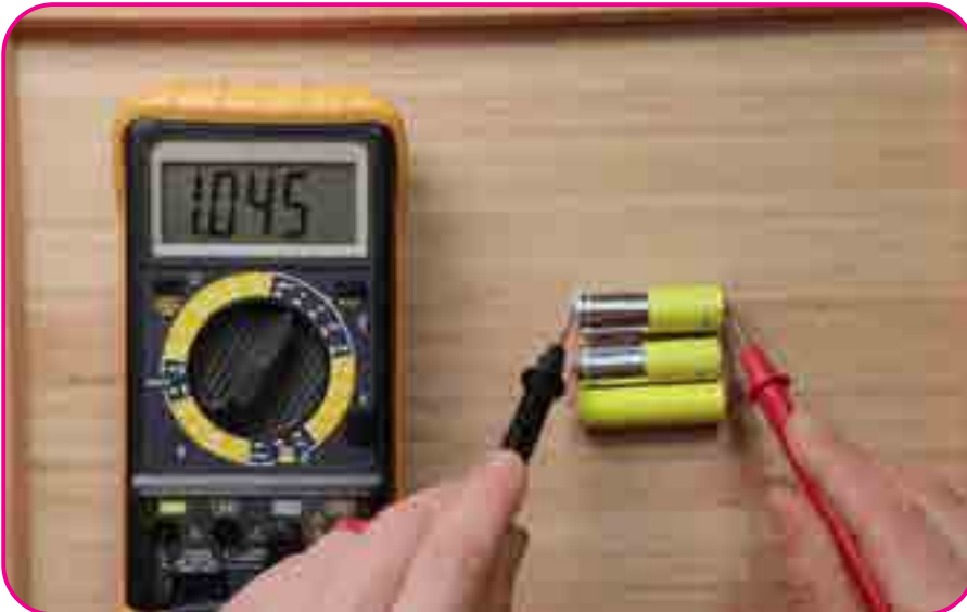
Görsel 6-Dijital Multimetre ile Kalem Piliin Ölçülmesi
